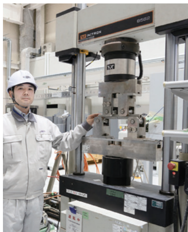
実際の配管を用いた試験。炭素鋼、ステンレス鋼、ニッケル合金など、原子力発電所で用いられる材料を中心に実施。
